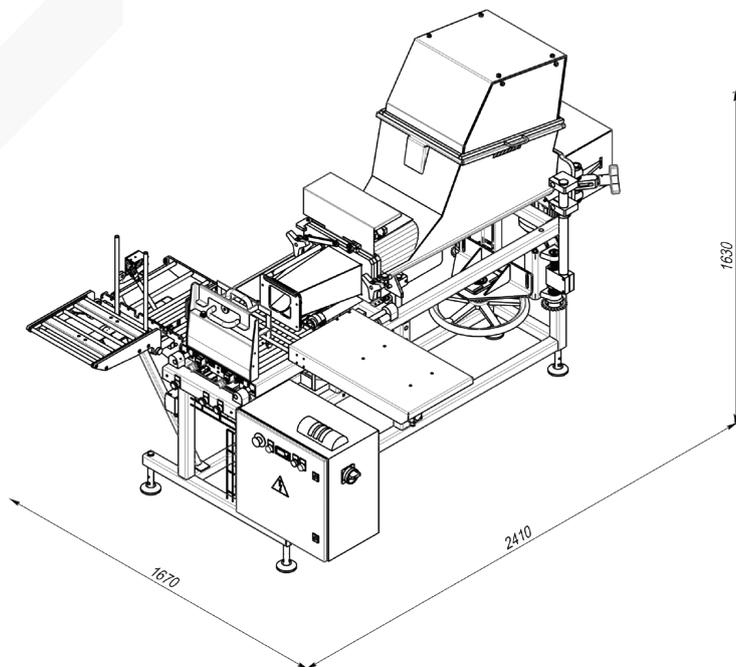
Машина для фасовки сливочного масла ORG - это полуавтоматическая фасовочная машина, предназначенная для фасовки сливочного масла в короба.
